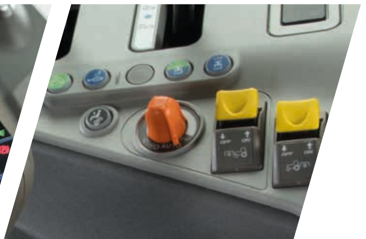
> Fácil e intuitivo: con el selector de ajuste Eco/Power el operador puede cambiar el comportamiento del cambio APS (Automatic Powershift)
