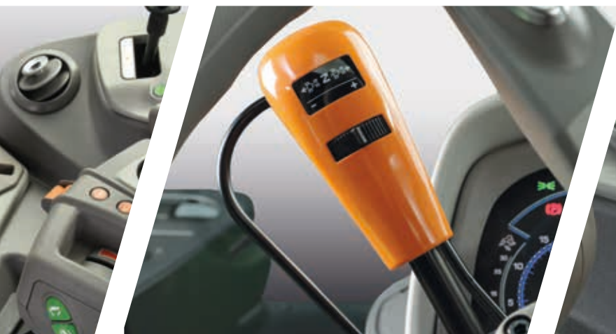
> Palanca del PowerShuttle con selector de ajuste SenseClutch
