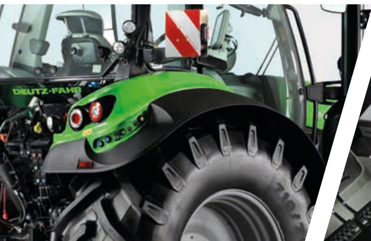
> Mandos externos a ambos lados para el elevador trasero, la TDF y hasta un distribuidor.
